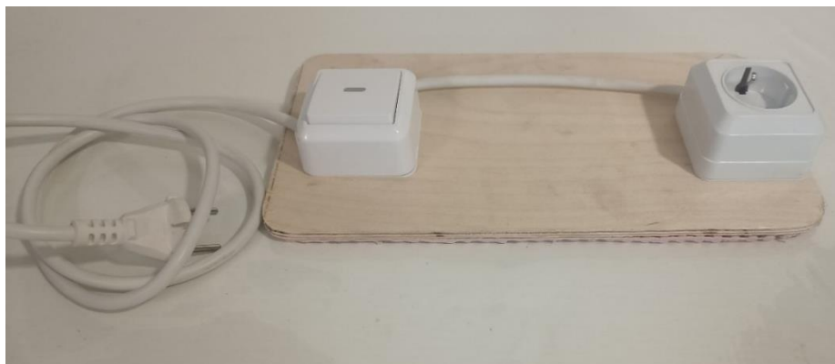
Рис. 1 Адаптер включения электрических приборов с большой клавишей
