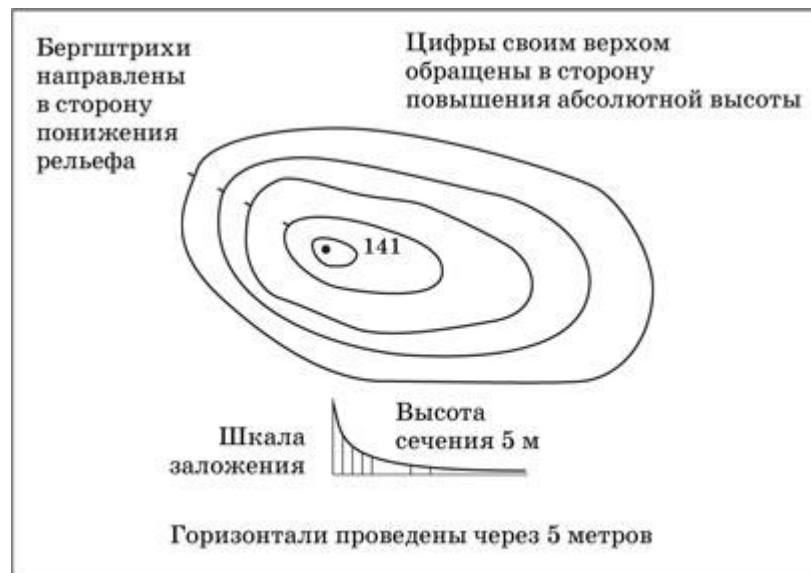
Рис. 6. Изображение холма горизонталями
